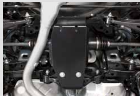
43 Differenzialschutz hinten ★ E515EAJ300 Zum Schutz des Differenzials vor Beschädigungen von unten. *Voraussichtlich lieferbar Dezember 2009. Einbausatz zur Montage zusätzlich notwendig.
